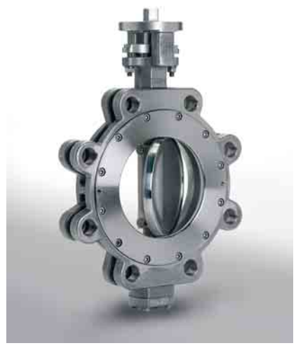
HGT 7...межфланцевая заслонка с резьбовыми отверстиями (water type) Ду 80 - Ду 300 Может быть установлена любой стороной. DIN EN.1092-1 Ру 10 - Ру 40. Класс по ANSI 150/300
